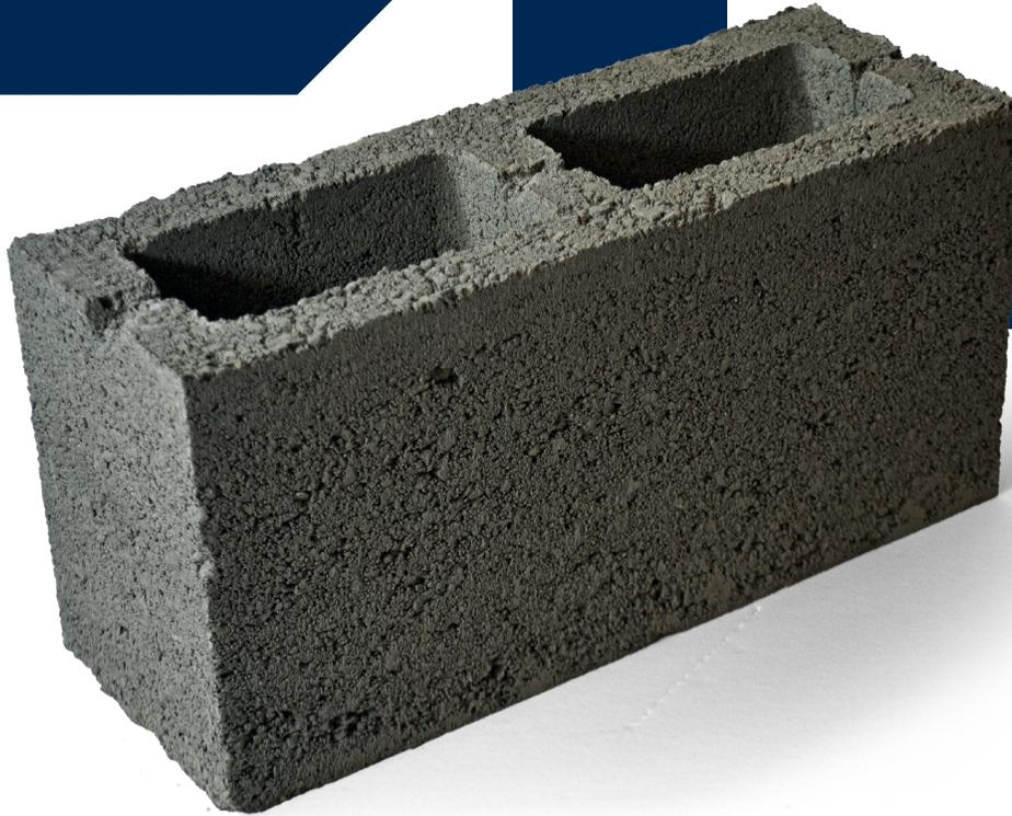
Elemento prefabricado de concreto y material calizo. Fabricado con un sistema de vibrocompactación. Su principal característica es que no tiene poma y posee baja absorción. Se utiliza en la construcción de muros y paredes con dimensiones normadas.
