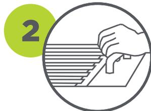
Con el lado liso de una llana metálica aplique una capa de adhesivo sobre la superficie haciendo presión. Aplique más material y peine con la parte dentada de la llana dejando líneas en un solo sentido. En la colocación de porcelanatos, grandes formatos, piso sobre piso y piezas en exteriores tráficos intensos, debe aplicarle adicionalmente adhesivo al reverso de cada pieza de manera uniforme, para lograr un contacto completo y máxima adherencia.
