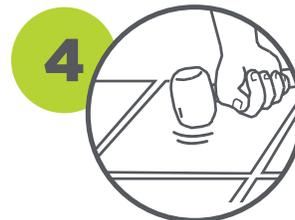
Golpee ligeramente las piezas con un mazo de goma para ajustar cada una en su lugar, hasta hundir una cuarta parte de la pieza en el adhesivo. Retire el exceso de adhesivo fresco de las boquillas.
