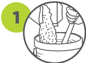
En 5-6 litros de agua limpia agregue gradualmente un saco de 20 kg o 0.5-0.6 litros para una bolsa de 2 Kg de Pegamix PSP mientras mezcla hasta obtener una pasta suave y sin grumos. Espere 10 minutos antes de usar la mezcla.
